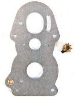
Drehmomentsatz Durch das kleinere Motorritzel erhöht sich das Drehmoment um ca. 20 %, die Geschwindigkeit des Modells verlangsamt sich. 8 Zähne Motorritzel · Getriebestirnplatte. Torque kit 20% more torque due to a smaller motor pinion. Reduced the speed of truck. BT pinion and gear front plate. N° 500907115
