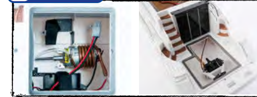
Elektromotor, Regler und Akku wassergeschützt untergebracht Electric motor, controller and battery protected from water ingress
