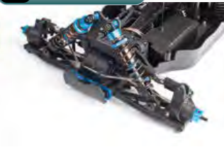
Viele Aluteile und Stabilisatoren bereits verbaut Stabilizers and many aluminum parts ready mounted
