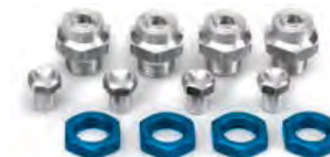
Radmitnehmer-Set Super Street 4WD Tamiya Buggies Bestehend aus: 4 Radmitnehmern für angetriebene Achsen und 4 blau eloxierten Radmuttern. Die Radmitnehmer passen für alle 1:8 Felgen mit einem 17 mm Sechskantmitnehmer.
