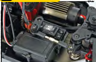
Das wasserfeste CS-9 Servo mit Metallgetriebe und 9 kg Stellkraft / The water resistant CS-9 servo with metal gear and 9kg torque power
