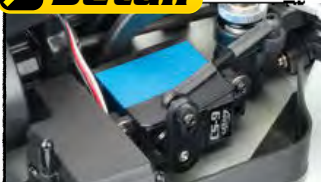
Das wasserfeste CS-9 Servo mit Metallgetriebe und 9 kg Stellkraft / The water resistant CS-9 servo with metal gear and 9kg torque power
