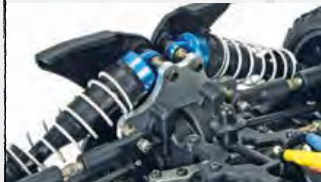
liegende, einstellbare Öldruckstoßdämpfer / horizontal, adjustable oil pressure shock absorbers
