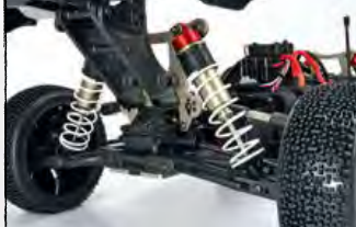
einstellbare Alu-Öldruckstoßdämpfer / adjustable alloy oil pressure shock absorbers
