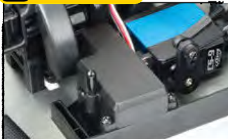
Staub- und schmutzdichte Akku- und RC Box / separate dust and dirt proof battery and RC box
