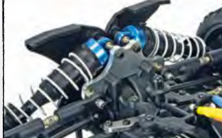
liegende, einstellbare Öldruckstoßdämpfer / horizontal, adjustable oil pressure shock absorbers
